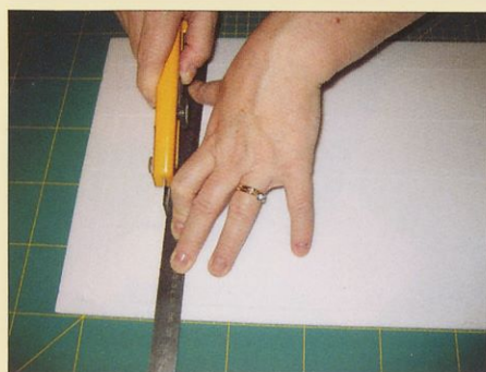
Slika 5. Prečno rezanje deprona
