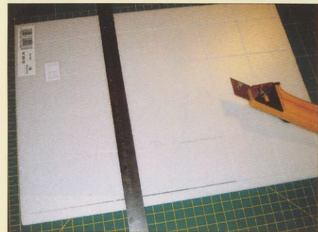
Slika 6. Zarezite le do oznak, da se kvadratni sestavni deli med rezanjem ne premikajo.
