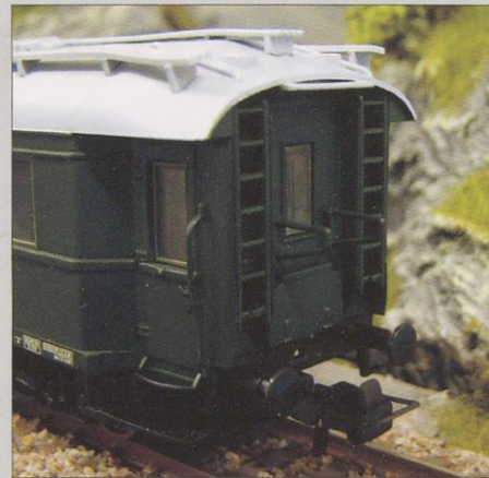
Slika 4. Varnostni ročaji na koncih vagona in lestve za vzpenjanje na streho vagona
