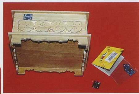
Slika 14. Majhna šarnirja (22 x 17 mm) lahko nadomestite z ozkim prilepljenim trakom usnja ali keper traku.
