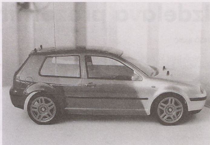
Slika 7. Ko na model povežemo karoserijo, se prepričajmo, ali so odprtine za kolesa dovolj velike, da ne bodo ovirale vrtenja, še zlasti obračanja sprednjih koles pri zavijanju.
