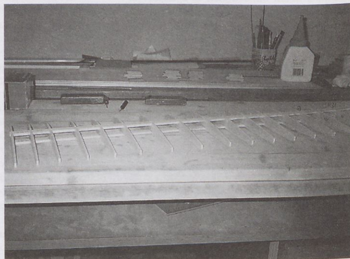
Slika 2. Skelet centropplana pred zapiranjem nosilca
