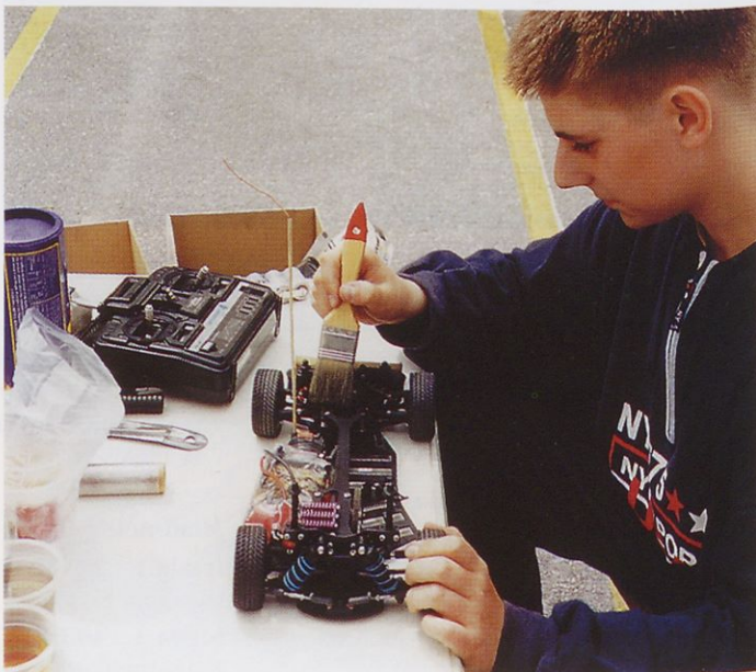
Po vsaki vožnji je priporočljivo model vsaj nekoliko očistiti in pregledati, če ni v kakega od vrtljivih delov zašel drobec peska ali druga nesnaga. Takole je to počel državni prvak v kategoriji elektro 4WD, Aleš Dobnikar.
