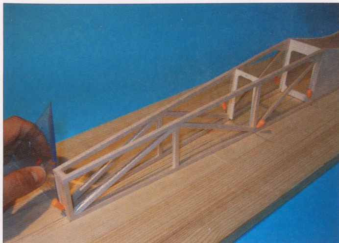
Na šablonsko desko zarišemo os trupa in položaje reber z njihovimi širinami. Sledi lepljenje in spajanje stranic trupa. Tudi tu pazimo na pravokotnost lepljenec in ravnost trupa.
