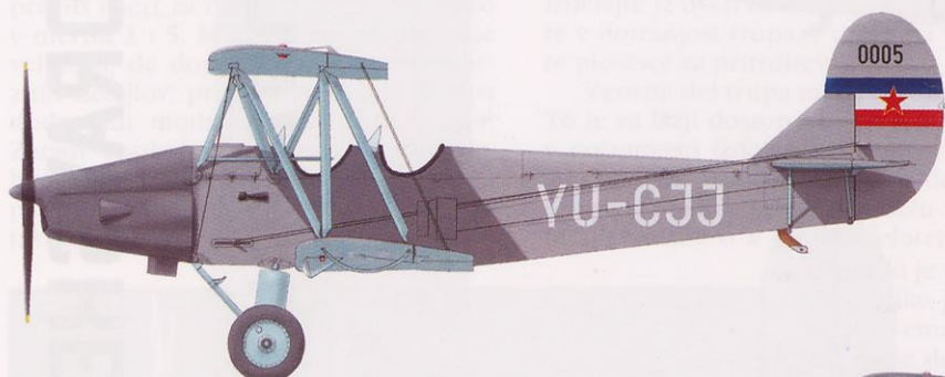
Po-2W: Letalo Alpskega letalskega centra v Lescah po opravljenem popravilu po zasilnem pristanku marca 1962
