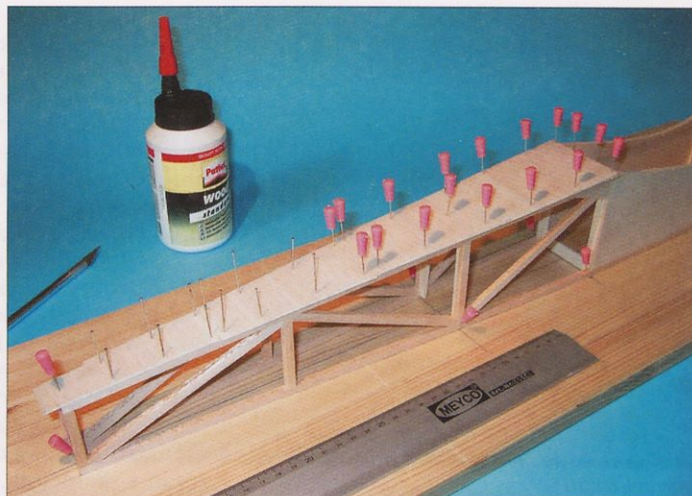
Preden trup snamemo s šablonske deske, ga s spodnje strani prekrivamo z balzovimi oplatami debeline 1,5 mm. Letnice v oplatah naj potekajo prečno na trup.
