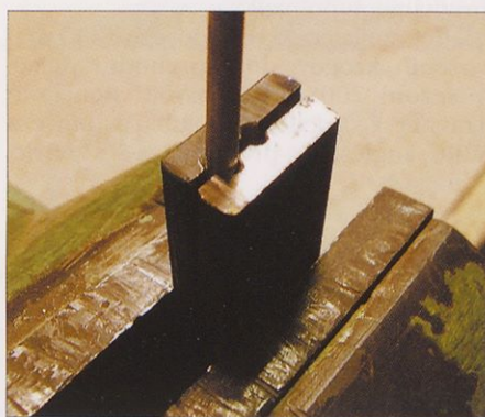
Primež stisnemo do konca, da se cevka v orodju pravilno deformira.
