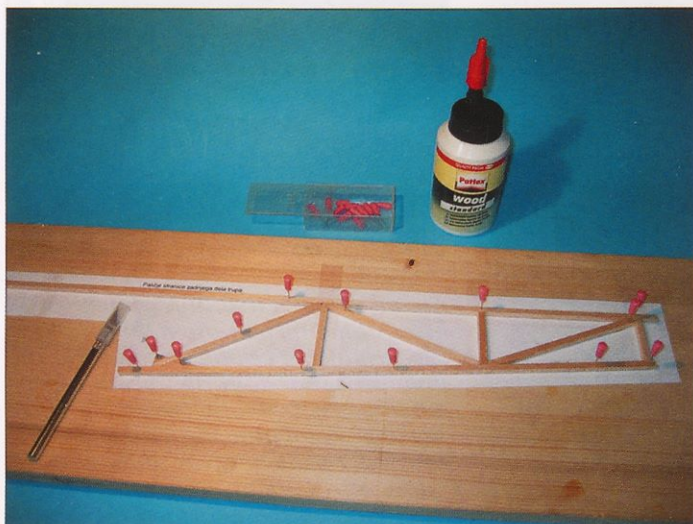
Da bi bil zadnji del trupa čim lažji, ima ta paličasto konstrukcijo. Izdelamo jo na enak način kot repne površine prek načrta na šablonski deski.
