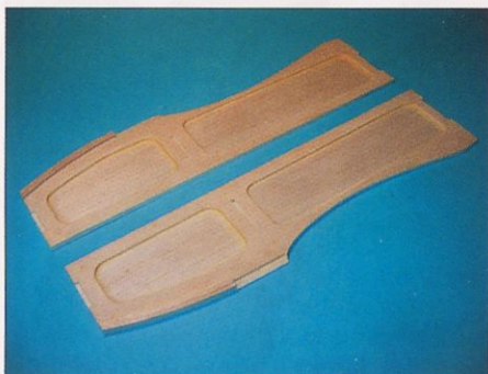
Na balzovi oplati, ki sta stranici trupa, prilepimo notranje ojačitve iz topolove vezane plošče. Pri lepljenju pazimo, da naredimo eno levo in eno desno stranico.
