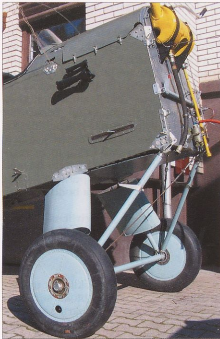
Robustno podvozje je preneslo marsikateri trd pristanek. (Foto: Aleš Jevšnik)
