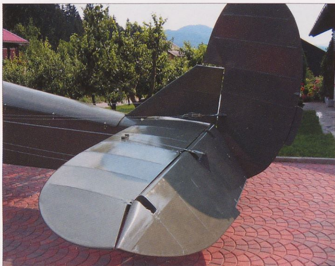
Detajl višinskega stabilizatorja in krmila (Foto: Aleš Jevšnik)
