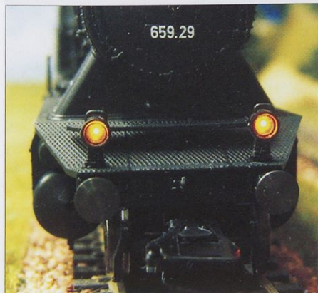
Slika 6. V žaromete vgrajene svetleče diode svetijo enako močno tako med vožnjo kot pri mirovanju modela.
