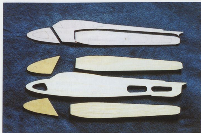
Slika 1. Kartonske šablone in vsi osnovni deli trupa
