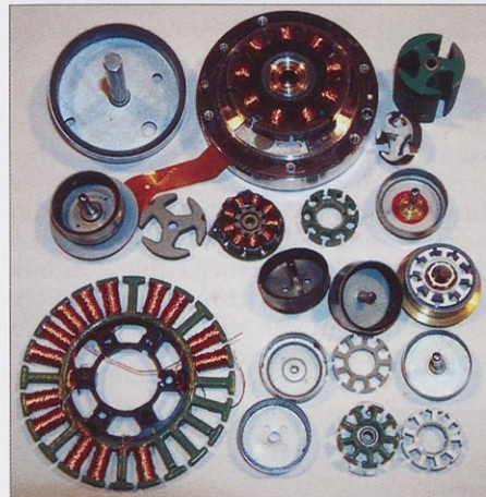
Slika 1. Deli različnih trifaznih motorjev. Zgoraj levo motor iz videorekorderja, spodaj levo motor iz disketnika, drugo so motorji iz CD-pogonov.
