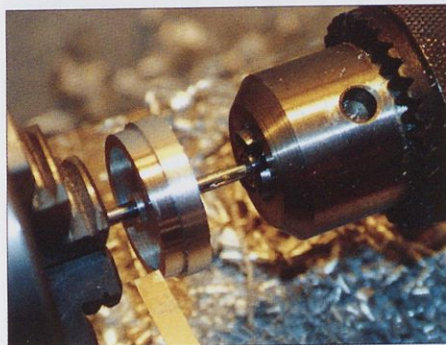
Slika 7. Struženje rotorja na gredi motorja
