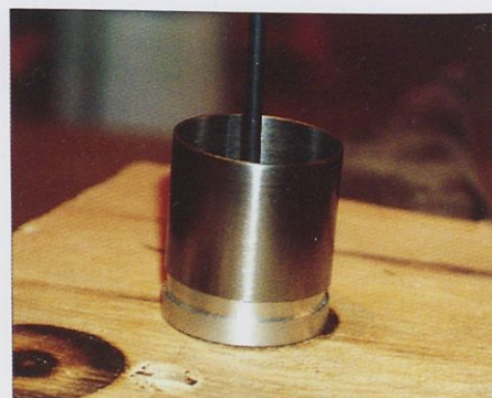
Slika 8. Montaža železnega tulca
