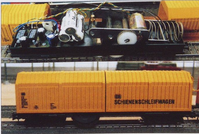
Čistilni vagon proizvajalca LUX-Modellbau mehansko očisti vsa nečistoča s tirov, za kar poskrbi vrtljiva krtača.
