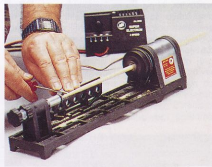
Daljše obdelovance do premera 12 mm stružimo tako, da jih potisnemo skozi votlo vreteno.
