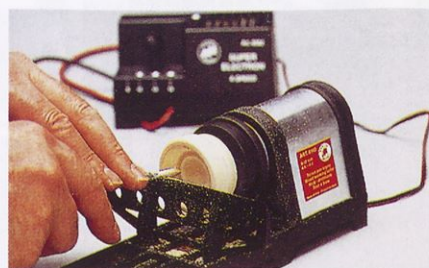
Pri čelnem struženju postavimo vodilo dleta pravokotno na os vrtenja.
