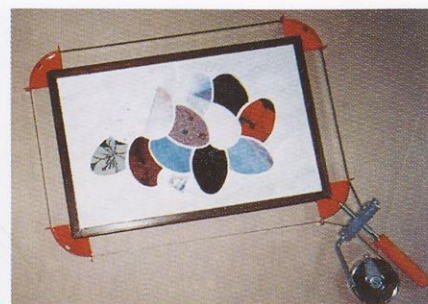
Slika 6. Pladenj med sušenjem lepila, s katerim so prilepljene letvice okvirja
