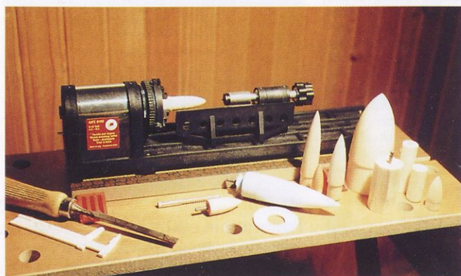
Mantuina lesna stružnica je tisto, kar so si raketni modelarji že od nekdaj želeli. Na njej lahko izdelujejo glave iz raznih vrst lesa ali plastike.
