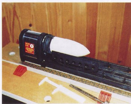
Če obrnemo vodilo dleta, lahko stružimo tudi glave večjega premera, toda le, če so iz balze.
