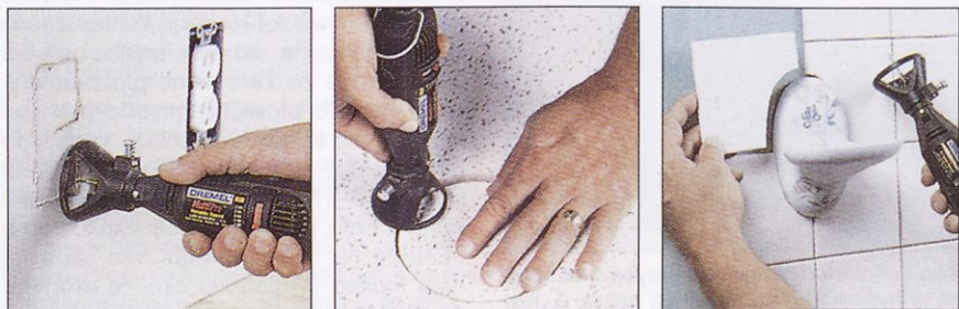
Slika 2. Ob uporabi različnih rezkarjev lahko z rezkalnim nastavkom poljubno izrezujemo mavčne plošče, les, laminato, akril, plastiko in keramične ploščice.
