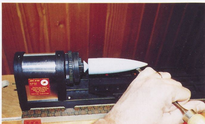
Glave za raketne modele običajno stružimo brez uporabe konjička. Oporo zagotavlja lesni vijak, ki mu odžagamo glavo in ga privijemo v obdelovanec.
