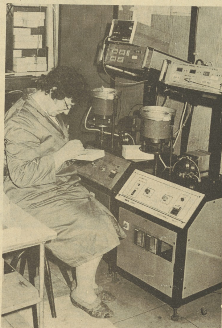
Čeprav že sama linija omogoča ugotavljanje kakovosti uporov, so delavke še vedno tiste, ki rečejo končni »da« ali »ne«
