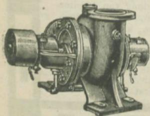
**Nieder- und Hochdruck-Zentrifugalpumpen**
