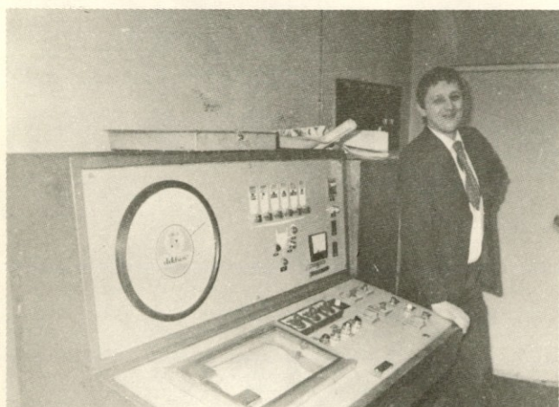
"Libelin" komandni pult z elektroniko predstavlja iz mešalca predstavlja "možganski center" celotne mešalnice.
