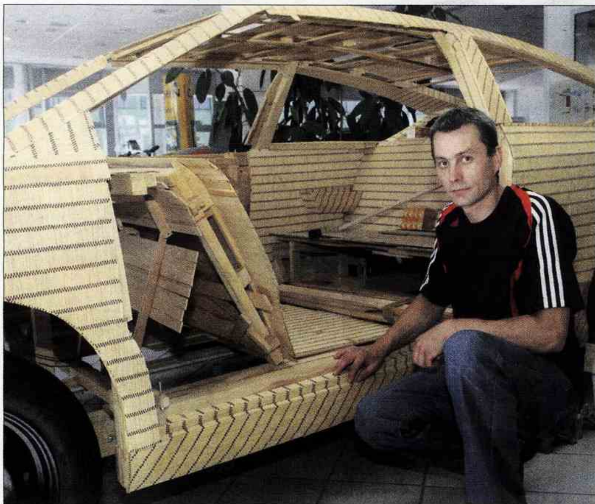
Odstopanja v velikosti med maketo in originalnim Citroënovim vozilom so minimalna, največ pol centimetra.
