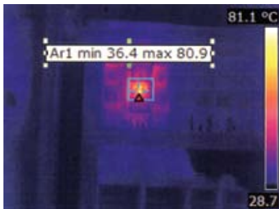
Slika 2: Vroča točka v električni omarici
