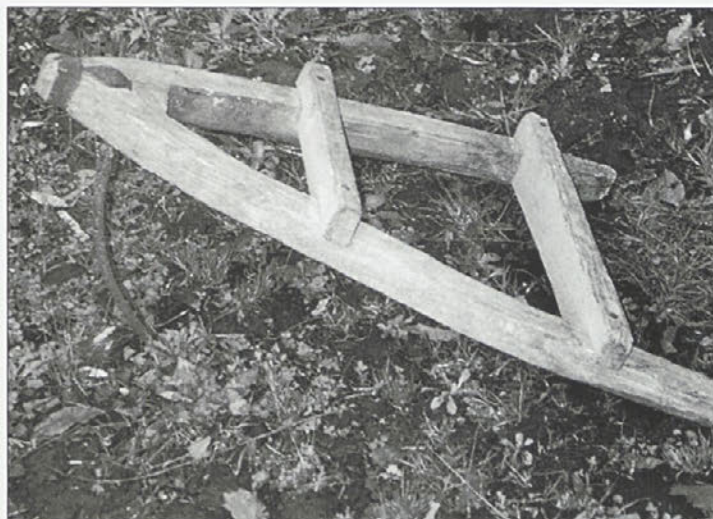
Hlapec za stanje na slammati strehi pri pokrivanju. Je iz leta 1920 pri Štefaniji Fajfar
