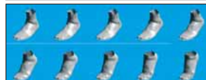
Slika 3. Zgoraj: Prva generacija laserskih merilnikov stopal, razvitih v KOLT-u. Spodaj: Primer meritve oblike stopala med sonožnim poskokom. Časovni interval med dvema zaporednima izmerkoma znaša 1/25 sekunde.
