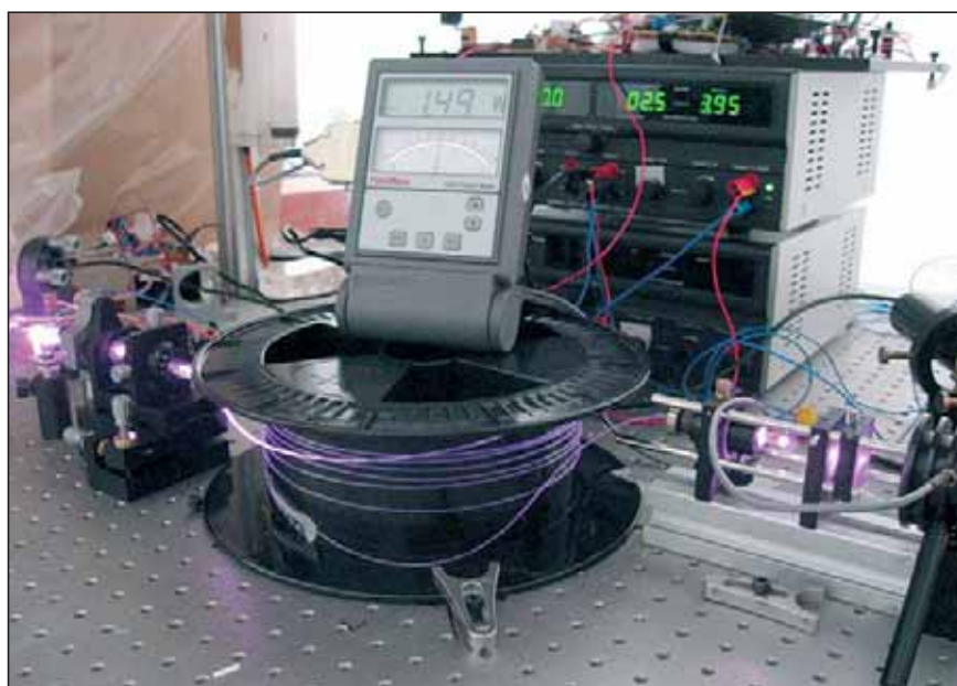
Slika 9. Laboratorijska izvedba kontinuirnega vlakenskega laserja med delovanjem
