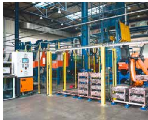
Slika 3: Šaržiranje rondelic z robotom
