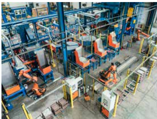
Slika 2: Robotizirana linija za površinsko obdelavo rondelic
