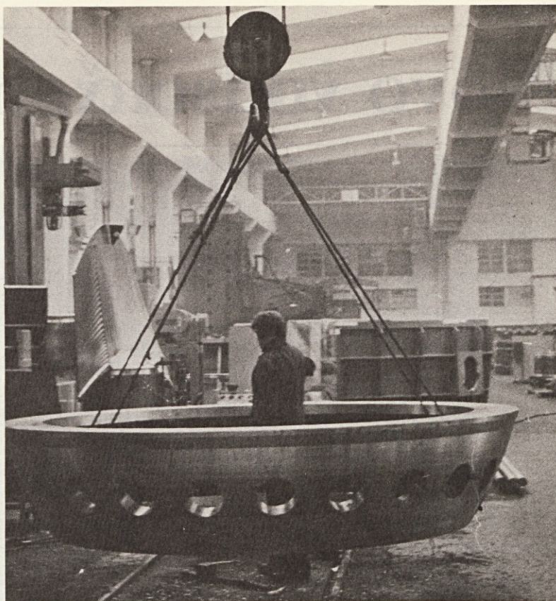
Notranji obroč vodilnika cevn turbine za HE Dubrava (6385 kg) je pripravljen za končno mehansko obdelavo (Foto: E. L.)
