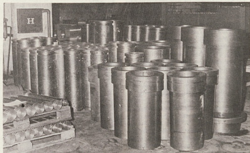
Valji hidravličnih cilindrov so znotraj še na grobo obdelani, prihajajo iz kooperacije med Romunijo in Litostrojem. Litostroj dobavlja Romuniji preoblikovalne stroje za razne uporabnike, od tam pa dobivamo sestavne dele v predobdelani obliki. Dokončane v Litostroju vgrajujemo v PO. (Vse fotografije razen prve je posnel Bogdan Francelj)
