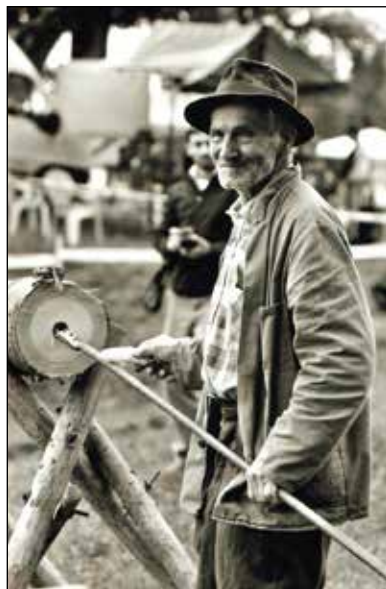
Janez Primožič pri prikazu izdelave lesene, vodovodne cevi. Foto: arhiv Janeza Primožiča
