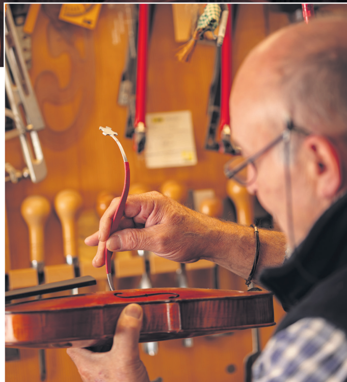
Mojster Skaza med popravilom dušice. »Smreka da violini ton, dušica ji doda dušo,« pove.
