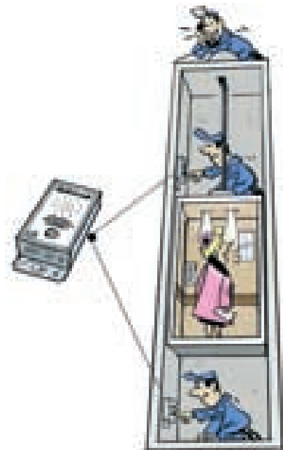
Slika 3. Z dvosmerno govorno napravo, ki naj ustreza standardu SIST EN 81-28, je mogoče alarmiranje v klicni center iz različnih področij oziroma delov dvigala, mogoče je dograditi tudi govorno povezavo s strojnico dvigala, ki je nujna pri postopkih reševanja, vzdrževanja in preskušanja, če se iz strojnice ni mogoče neposredno sporazumevati z osebami v kabini.
