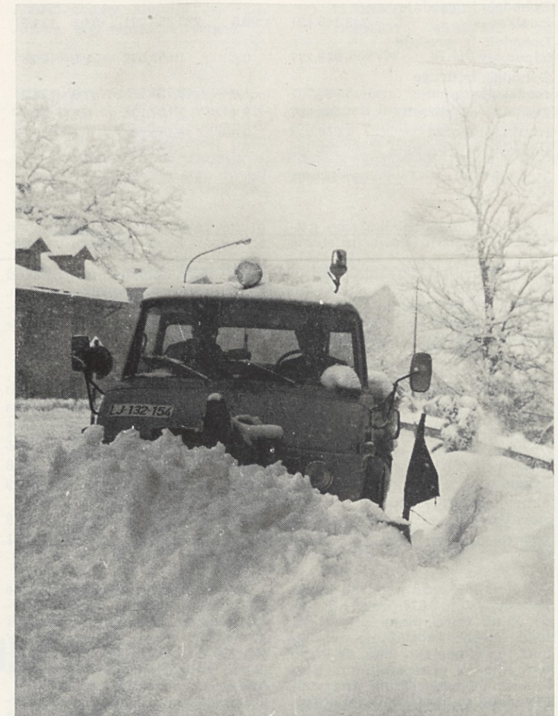
Vozilo Unimog se je ob snežnih marčevskih dneh izkazalo kot nepogrešljiv stroj. S priključkom snežnega pluga so očistili vso okolico in notranjost tovarniških poti
