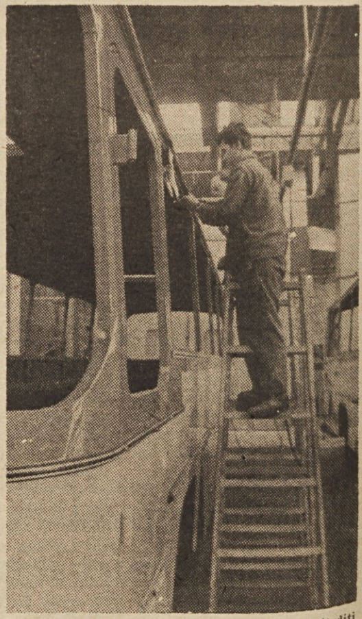
Po ličanju karoserije je treba vstaviti stekla, pritrditi sedeže, vgraditi izolacijo... in še in še je drobnih, a vseeno pomembnih del
