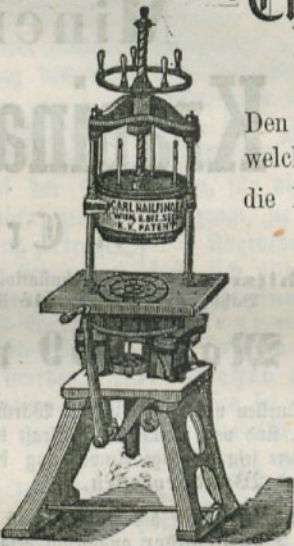
Teigtheilungs- od. Aufgebmaschine für Bäcker.
