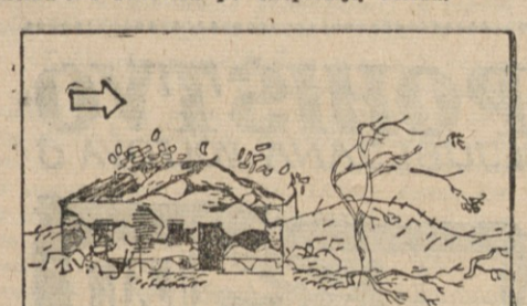
Slika 4. 2-4 sekunde po eksploziji. Zračne mase, izrinjene ob eksploziji, se vračajo na mesto vakuumu. Druga faza razdejanja ilše zaradi zračnega pritiska z leve.
