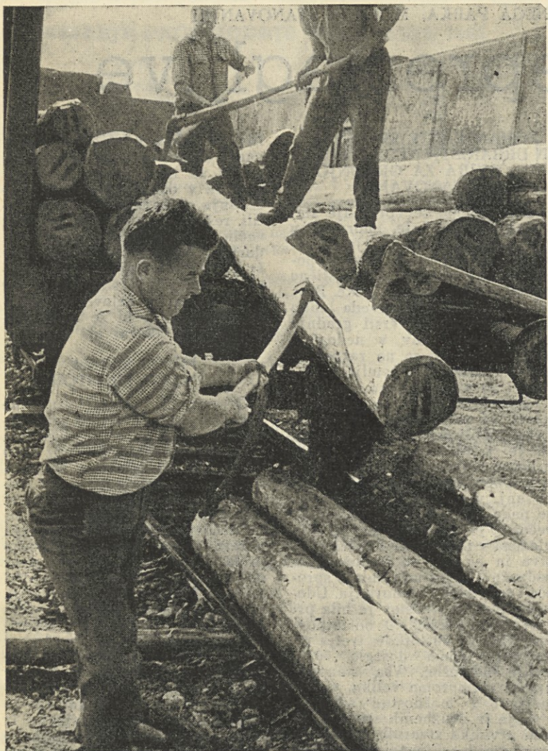
Dolgi les morajo iz vagonov razložiti zelo previdno, da se ne zgodi nesreča. Po razkladanju ga bodo prepeljali v čistilnico lesa, kjer bo razžagan na metre, očiščen in tako kmalu pripravljen za izdelavo lesovine
