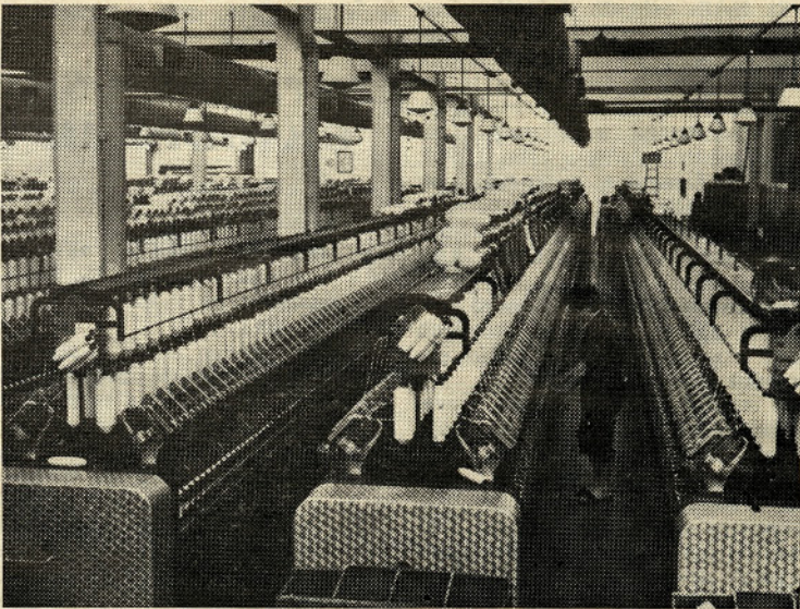
Prstančevi stroji v stari zgradbi
