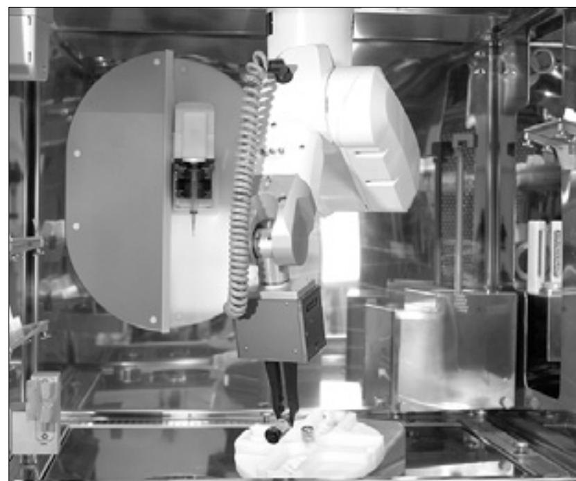
Robot podjetja Health Robotics pripravlja zdravila proti raku
