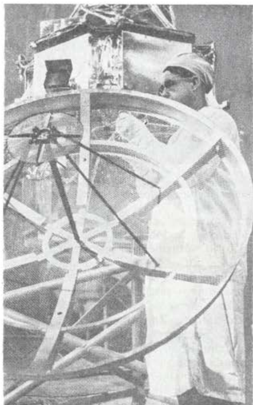
Tehnik pripravlja anteno vesoljske sonde, ki bo pošiljala slike Marsa
