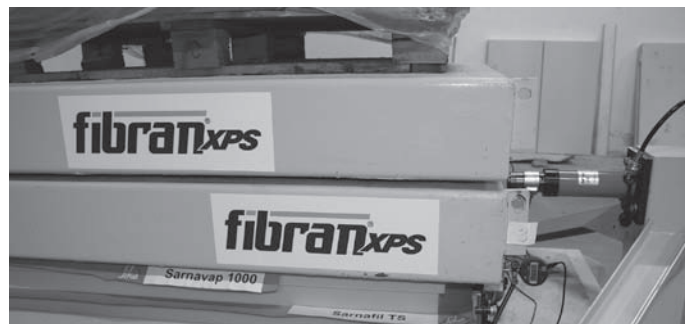
Slika 08: Eksperimentalne meritve strižne odpornosti toplotno-izolativnega ovoja zgradbe pod temeljno ploščo.
