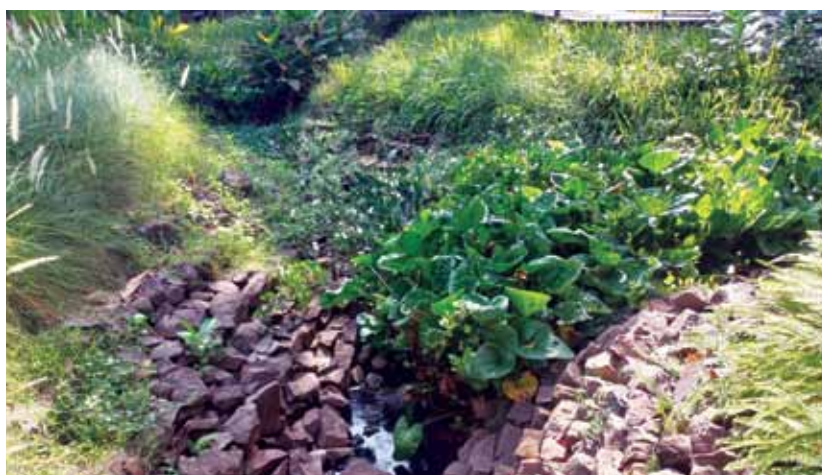
Slika 8: Biološki val omogoča ponikanje vode v globino.
