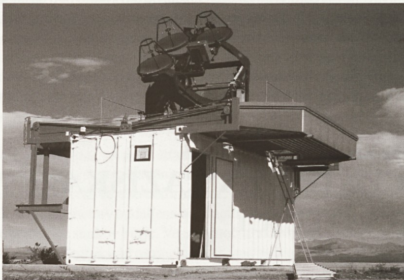
Na sliki: Lidar v provinci Mendoza v Argentini, ki ga je v okviru mednarodnega sodelovanja postavila Politehnika Nova Gorica. Podoben lidar bo nameščen na Otlici.
