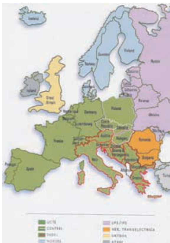
Interkonekcija UCTE se vse bolj širi tudi na vzhod in jug Evrope.
