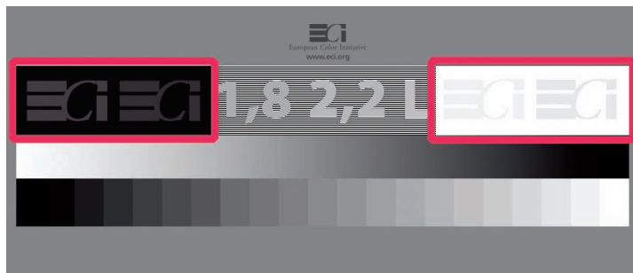
Slika 2. Nadziranje svetlosti in kontrasta. Logotip ECI na temnem in svetlem polju mora biti komaj viden; zaradi boljše ponazoritve je tu njegova svetlost korigirana.
