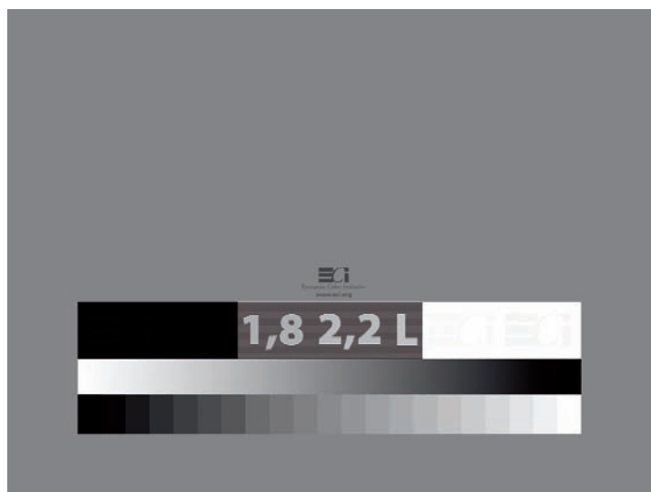
Slika 1. ECI Monitortest V1.0 pri zaslonski ločljivosti 1024 x 768 točk je na tej sliki močno pomanjšan. Skupno podpira na obeh računalniških platformah (PC, MAC) štirinajst ločljivosti.
