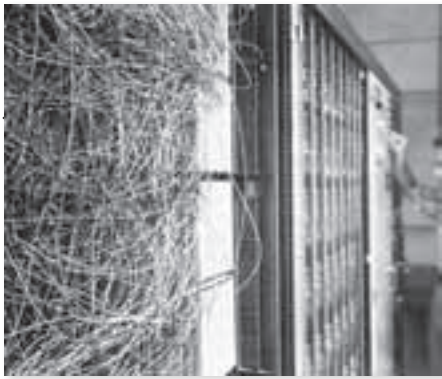
△ Mark 1 Perceptron iz leta 1958 - ta sklop elektronike v velikosti garderobne omare je bil razporejen v omrežju, ki spominja na nevrone.
