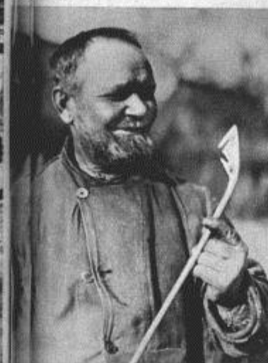
Der Strohdachdecker mit seiner Nadel, mit der er — wie lange auch — die Dachziegel aneinander befestigt
