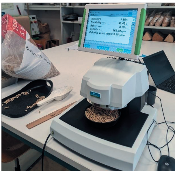
Slika 1. Hitra analiza peletov z NIR spektroskopijo v Laboratoriju za lesno biomaso, Gozdarski inštitut Slovenije (foto: D. Stare).
