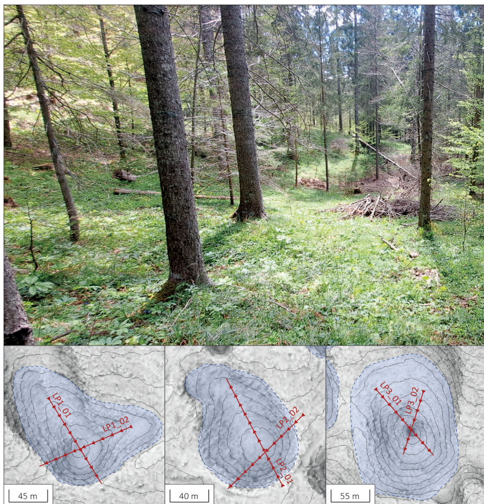
Slika 5: Podolgovata vrtača v Loškem Potoku (zgoraj) in prikaz postavitve ERT profilov na lidarski vizualizaciji z ekvidistanco 2,5 m (spodaj).
