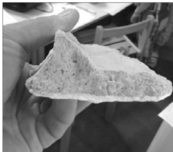
Kos betona v učilnici italijanske sekcije in okrušen strop nad vrta, ki vodijo na vrt
