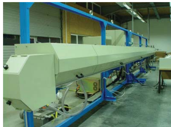
Sodobna plazemska naprava za plazemsko čiščenje brezkončno dolgih materialov (npr. žice) podjetja Plasmat iz Avstrije
