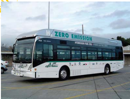
Slika 7: Mestne avtobuse na utekočinjen vodik je najverjetneje »pokopala« nepopolna toplotna izolacija rezervoarjev, ki povzroča konstantno uhajanje vodika.
