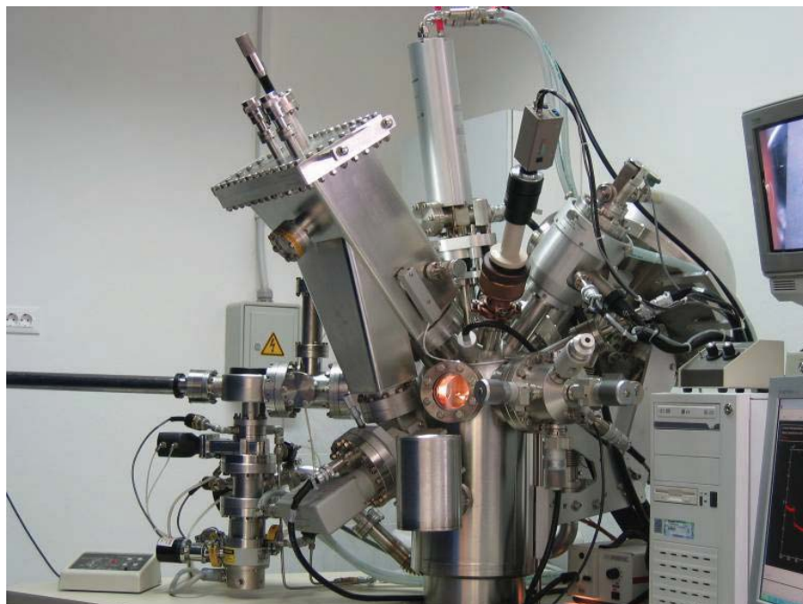
Slika 1: Spektrometer za rentgensko fotoelektronsko spektroskopijo – XPS na Institutu "Jožef Stefan". XPS-spektrometer je kompleksen instrument, sestavljen iz vakuumske komore, rentgenskih izvirov, elektronskega analizatorja, nosilca vzorcev, ionske puške, vakuumskih črpalk in drugih komponent. Tlak v XPS-spektrometru je približno 3 \cdot 10^{-10} mbar.
