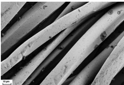
Površina umetne žile pred plazemsko obdelavo (zgoraj) in po njej (spodaj). Drobne ploščice na površini so trombociti.
