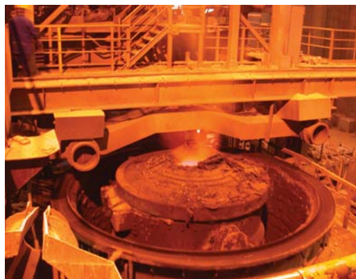
Slika 3: Shema naprave za vakuumsko razplinjevanje (levo) in vakuumska posoda za razplinjevanje nerjavnega jekla v železarni Acroni, Jesenice, ki jo izčrpajo do tlaka nekaj deset milibarov s črpalko z vodnim obročem (desno)
