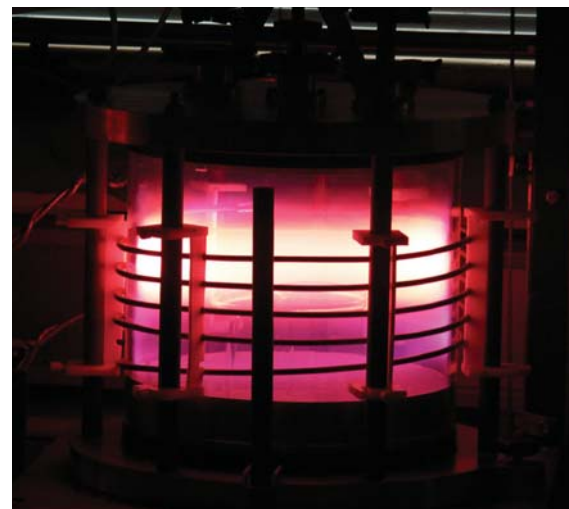
Dvajsetlitrski plazemski reaktor za aktivacijo polimernih materialov. Plazmo vzbujamo z RF-generatorjem frekvence 27,12 MHz in nazivno močjo 2000 W.
