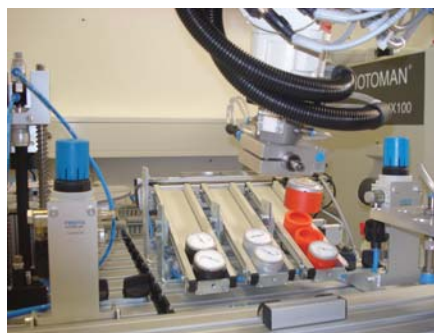
Slika 2: Robot na koncu linije pobira izdelke in jih zlaga na paleto.
