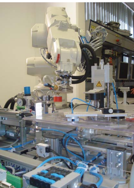
Slika 6: V celico je vključen tudi mehatronski sistem Festo MPS205, ki ga krmili električna učna plošča EUP-3.
