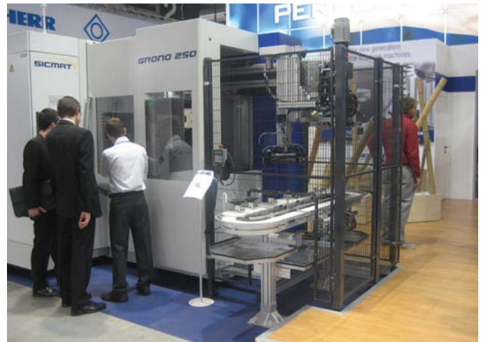
Transportni trak s paletami za obdelovance in izdelke kot vmesni zalogovnik ter robot za strego stroju
