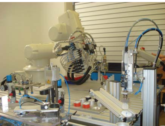
Slika 1: Osnova didaktične robotske celice je industrijski robot Motoman HP5.
