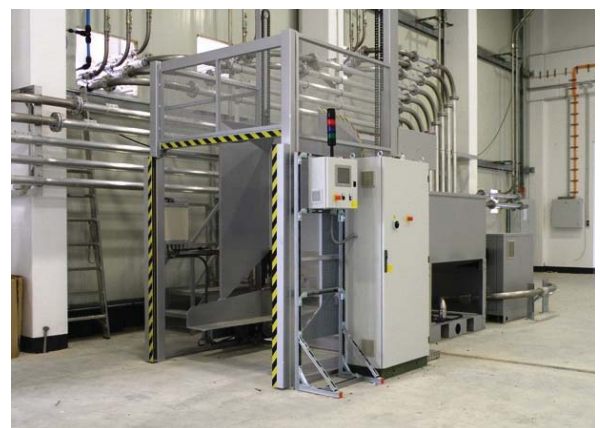
Avtomatska praznilna postaja s čitalnikom kode, dvigalom, IR-senzorji za varovanje uporabnika (opcija) in neposredno povezavo v centralni sistem
