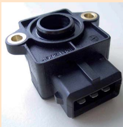
Senzor kota za določanje položaja dušilne lopute, za 2/3/4 kolesnike (odjemalci: BMW, Bing, Dellorto)
