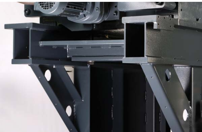
Ojačeno ogrodje stroja z odebeljenimi ležišči vodil
