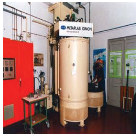
Slika 9: Naprava za pulzno plazemsko nitiranje na Inštitutu za kovinske materiale in tehnologije v Ljubljani
