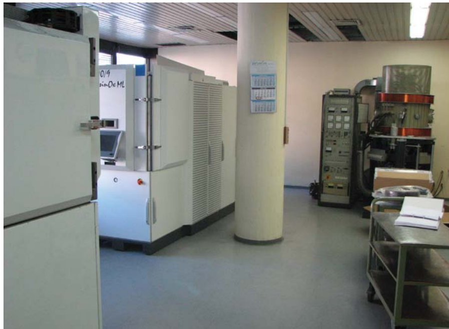
Slika 7: Naprave za nanos trdih zaščitnih prevlek na orodja in strojne dele v Centru za trde prevleke na Institutu "Jožef Stefan"
