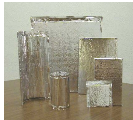
Slika 9: Videz vakuumskih izolacijskih plošč, v katerih je trda pena z odprto strukturo
