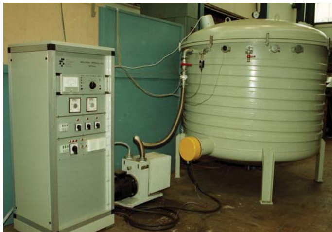
Slika 12: Shematski prikaz impregnacijske naprave s tekočim impregnantom za impregniranje transformatorskih navitij, kondenzatorjev itn. (levo); vakuumska impregnacijska naprava, ki jo je izdelal Institut "Jožef Stefan" za Prirodoslovni muzej Slovenije za impregnacijo okostja ledenodobnega mamuta (desno)
