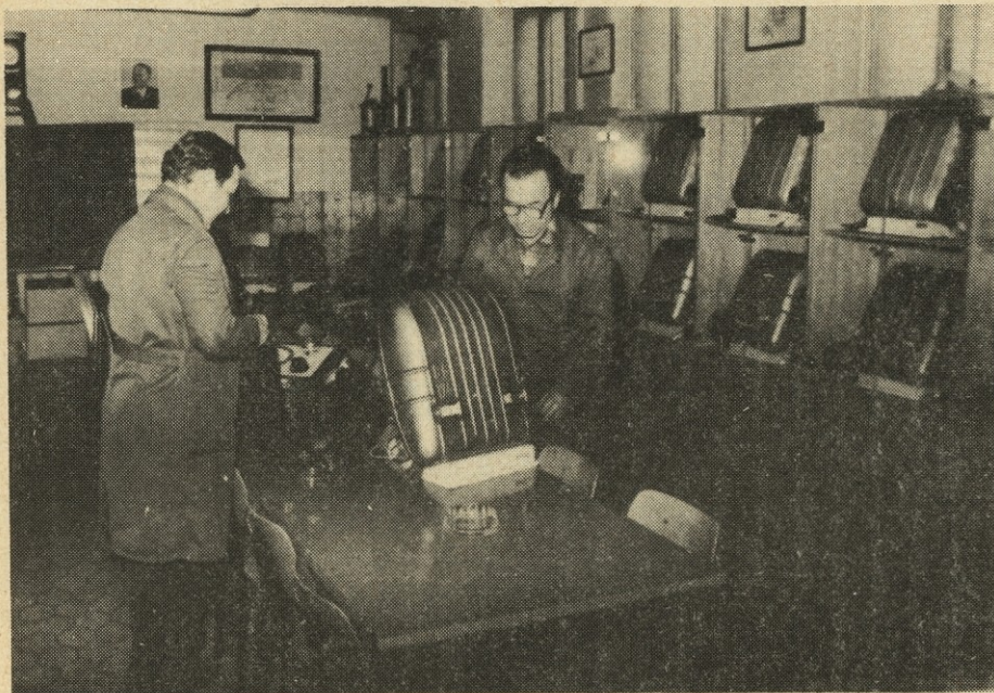
Ivan Zupan in Bruno Pust skrbita za normalno delo reševalne postaje na rudniku Hrastnik. Tu je nameščenih in pripravljenih za primer nesreče več vrst reševalnih aparatov; 10 komadov BG-174, 10 kom R-12, 10 kom BG-160. (Foto: J. Kirič)
