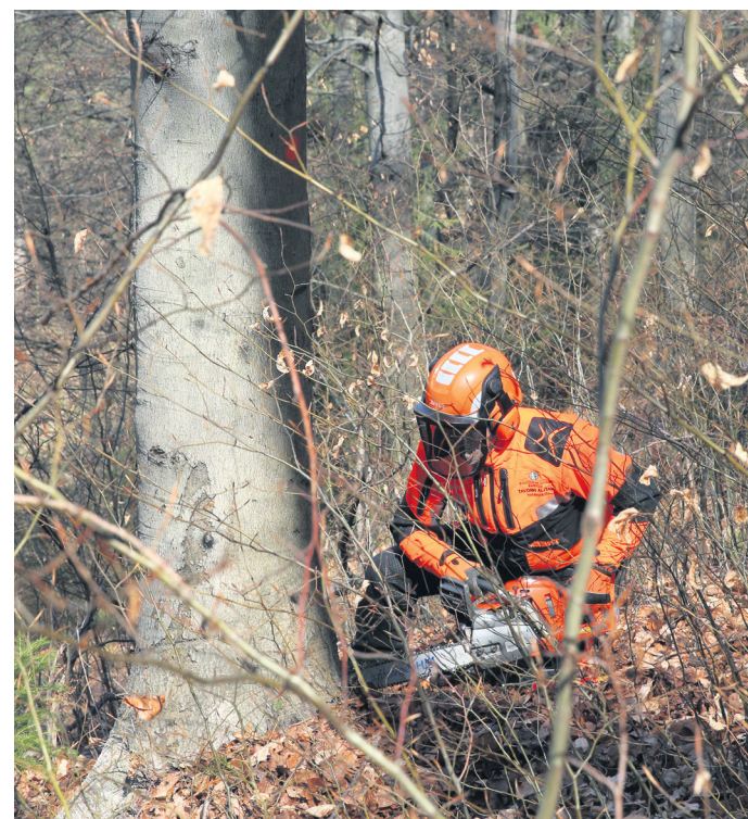
Pri donosu je zelo pomembno krojenje lesa. Gozdarji morajo hloed odrezati tam, kjer je grča, ker je brez napak višje cenjen. (Foto: SHERPA)
