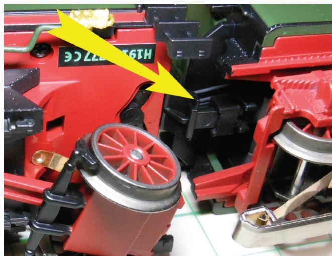
Spodnji del spoja med lokomotivo in vlečenim zalogovnikom je skonstruiran tako, da lahko uporabnik izbira med krajšo ali daljšo različico spoja.
