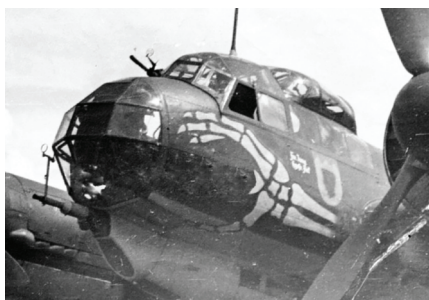
Ju 88A-4 štaba StG 77. Top MG FF pod nosom ima merek na nenavadno dolgi palici.
