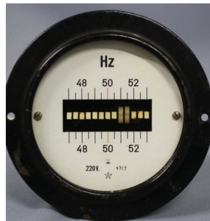
Resonančni frekvencmeter med leti 1900 in 1940. Zaradi simpatičnega prikaza ga še vedno lahko srečamo v industrijskih obratih.
