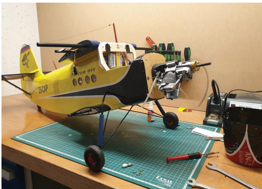
An-2 v delavnici Uroša Markiča ima na novo izdelano požarno steno oziroma nosilec motorja (Foto: Uroš Markič)
