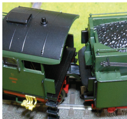
Spoj med lokomotivo in vlečenim zalogovnikom, skozi katerega poteka devet električnih žic, omogoča v zavoju tolikšen odmik, da lahko lokomotiva vozi po zavojih z radijem 360.
