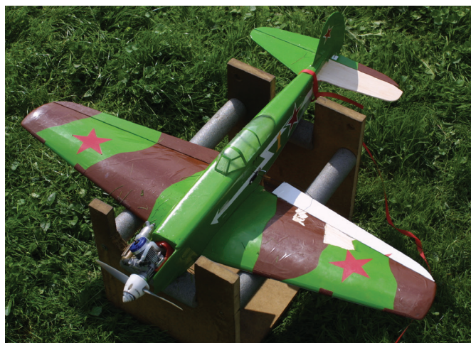
Popravljen model s krilom drugega modela, krilcem s tretjega in zasilnim višinskim stabilizatorjem
