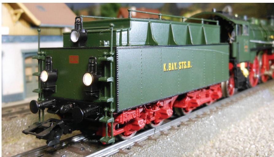
Zadnji del vlečenega zalogovnika krasijo tri velike laterne (žarometi), v katerih so vgrajene bele svetleče diode. Tretja zgornja luč deluje neodvisno od spodnjih dveh.
