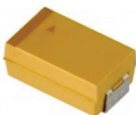
Tantalni kondenzator (C3). Črta označuje pozitivni priključek.
