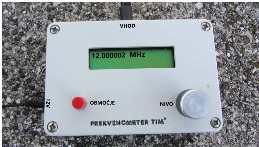
Zgornja frekvenčna meja Timovega frekvencmetra je 50 MHz.
