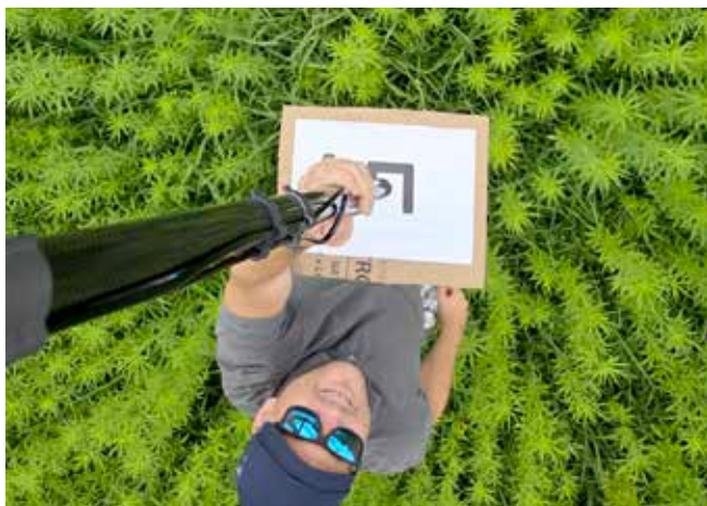
Merjenje lokacije oslonilne točke v laboratorijskem poskusu z industrijsko konopljo, za izdelavo digitalnega modela polja
