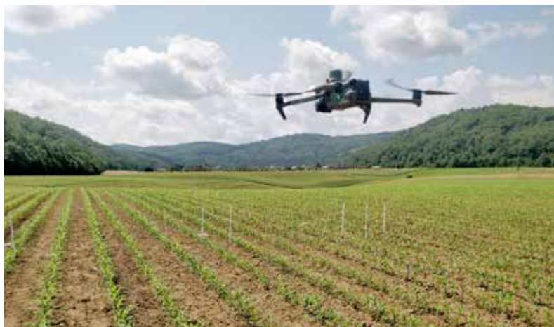
Letenje z brezpilotnim letalnikom nad poljem koruze, za izdelavo modela polja
