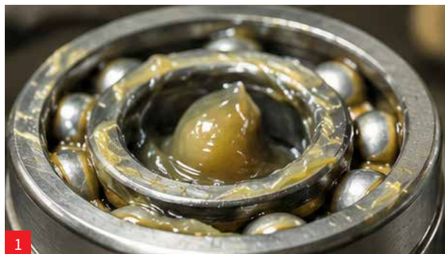
Prekomerno mazanje kotalnega ležaja (Vir: [7])
