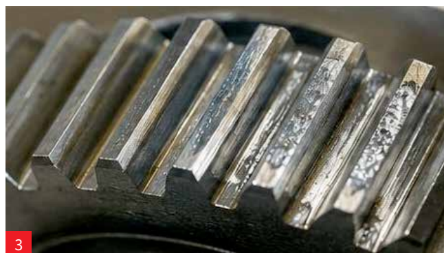
Obraba zobnika zaradi neustreznega mazanja (Vir: [7])
