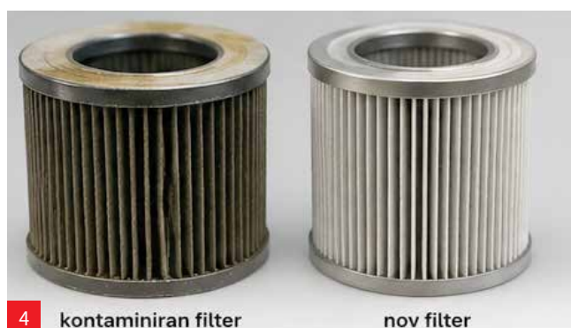
Kontaminiran filtrski element hidravličnega sistema (Vir: [7])
