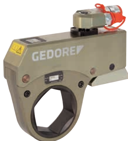
Kasetne glave LDK – izredno nizka višina. Za dimenzije od 32 do 130 mm in napore od 160 do 24.000 Nm.
