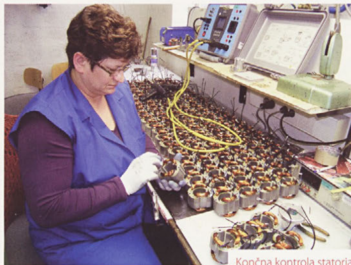
Končna kontrola statorja
