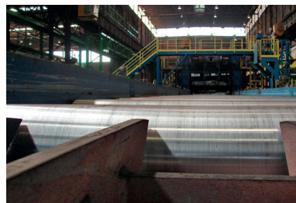
Valjčnice z navarjenim materialom na površini
