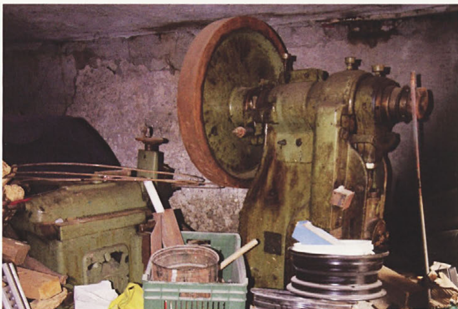
Skobeljni stroj proizvajalca KLOPP Werke GMBH, Solingen, Nemčija, 1938 in 30-tonska stiskalnica proizvajalca Henrika Stolca sinovi, Novi Sad, Srbija, 1938 [1].
