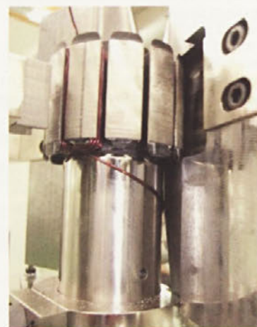
BWM-100 Povezovalno zaporedje na spodnji strani statorja
