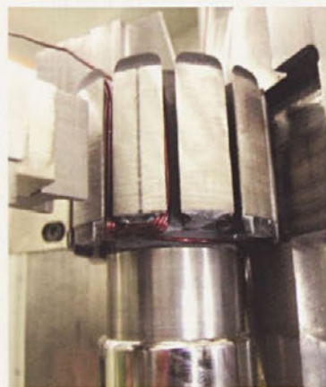
BWM-100 Povezovalno zaporedje na spodnji strani statorja
