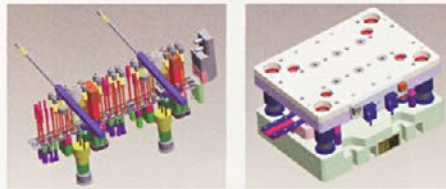
Slika 1: Model orodja; levo: aktivni deli orodja, desno: kompletni sestav orodja
