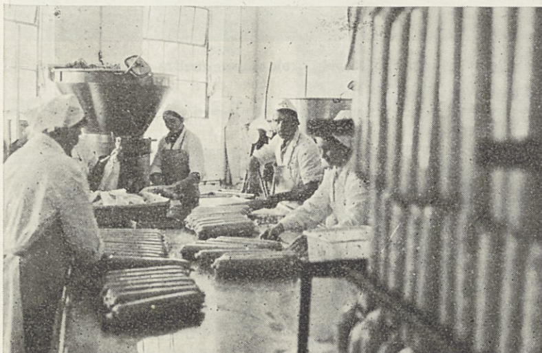
Polnilnica. S posebnimi polnilnimi stroji polnijo maso za salame in druge mesne izdelke v naravna in umetna čreva.
