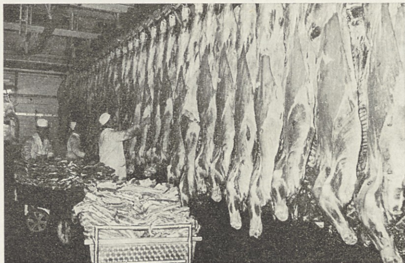
S transportnimi »mački« nato zaklano živino prepeljejo v predhladilnico in nato v hladilnico za dokončno razhlajevanje mesa.
