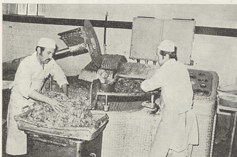
In že smo v predelavi mesa. Razsekujejo ga, meljejo v posebnih strojih in dodajajo razne vrste začimb, kar je pač odvisno od vrste izdelka.
