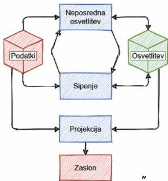
Slika 1: Postopek upodabljanja s hibridno difuzijsko metodo. Vhodni podatki so uporabljeni za izračun neposredne osvetlitve in sipanja, katerih skupni rezultat je obevalni volumen. V zadnjem koraku vhodne podatke združimo z osvetlitvijo in jih projiciramo na zaslon.
