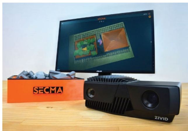
» Barvna kamera Zivid One Plus 3D je sestavni del rešitev podjetja SECMA na področju pobiranja naključno postavljenih predmetov iz zalogovnika. | Vir: Zivid
