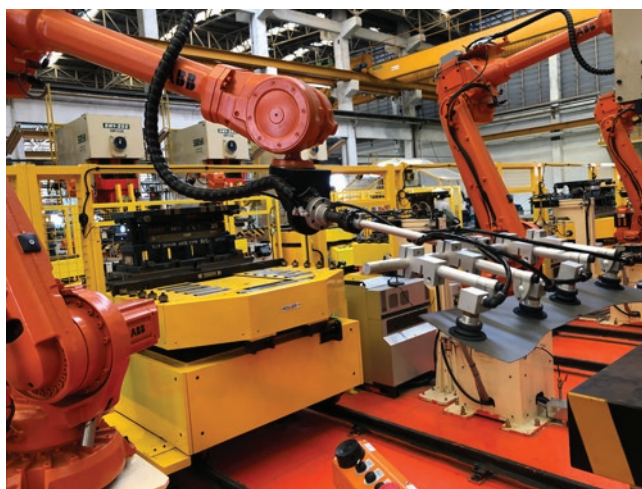
» Popolnoma avtomatiziran proces manipulacije obdelovancev med stiskalnicami. | Vir: FIPA
