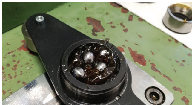
» Slika 2: Določanje mazalnih lastnosti masti in njene sposobnosti zaščite pred obrabo
