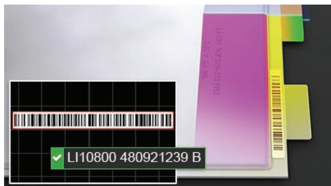
» Optično prepoznavanje znakov (OCR) z globinskim 3D-skeniranjem podatkov. | Vir: LMI Technologies
