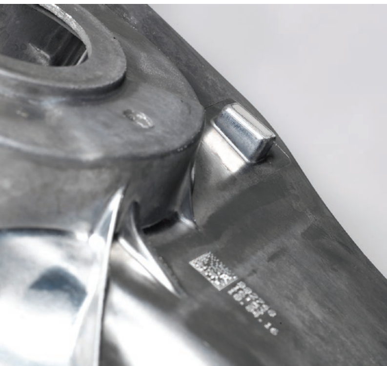
» Ulitek izdelan s postopkom tlačnega litja, ki ima vgrajen RFID transponder (pravokotna izboklina na zgornjem delu) in vtisnjen matrični koledar ter označilo izdelka (na spodnjem delu). | Vir: Fraunhoferjev inštitut IFAM
