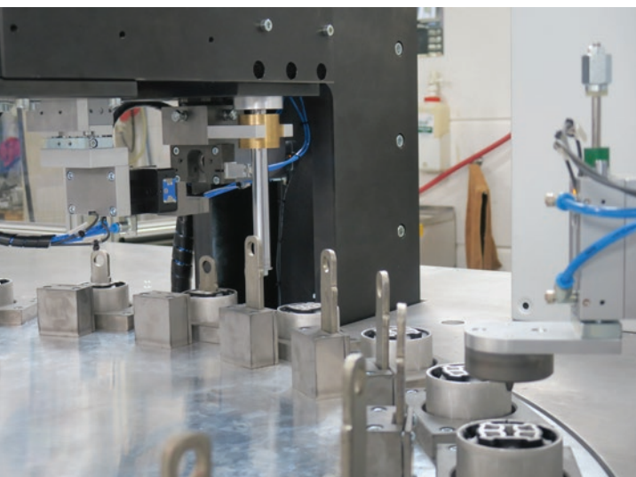
» Funkcija sprejema, prenosa in vtiskovanja, pri kateri je bilo uporabljeno kombinirano orodje za prijemanje in vtiskovanje.
