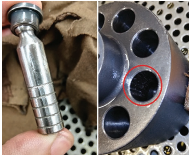
» Slika 2: Primer prekomerne obrabe aksialne batne črpalke hidrostatičnega pogona
