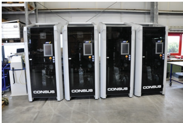
» Sistem ConSus zagotavlja manj emisij hrupa in trdih delcev v primerjavi s konvencionalnimi injekcijskimi sistemi za rezanje z abrazivnim vodnim curkom. | Vir: ANT
