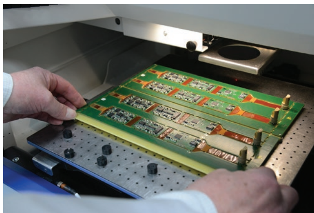
» Vstavljanje prožno togih plošč za vezja v laserski sistem MicroLine 2000. Ločevanje z lasersko tehnologijo je zelo ustrezen postopek pri kompaktni postavitvi komponent blizu roba plošče iz prožno togega materiala, kar predstavlja izziv za obdelavo. | Vir: ATLAS EMS
