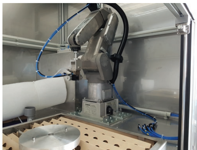
» Kompaktne celice za barvanje z roboti, ki so razviti posebej za tehnologijo barvanja, omogočajo cenovno učinkovito robotizirano barvanje. | Vir: Reiter Oberflächentechnik
