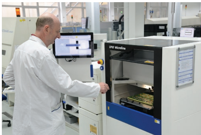
» V podjetju ATLAS EMS uporabljajo laserski sistem MicroLine podjetja LPKF za razslojevanje. Možnost hitre nastavitve vsake obdelave je pomemben dejavnik pri učinkoviti proizvodnji. | Vir: ATLAS EMS
