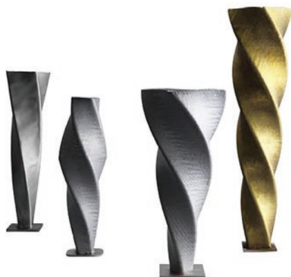
» S postopkom WAAM se lahko uporabijo različne kovine, kot so jeklo, aluminij, krom-nikljevo jeklo ali bron. | Vir: Fronius
