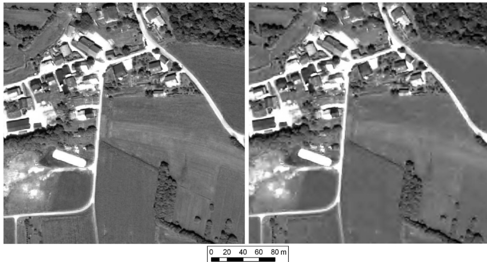
Slika 2: Izsek izvorne (levo) in stisnjene podobe s kompresijskim razmerjem 100 : 1 (desno). Razlika je najbolj opazna na homogenih površinah, kot so travniki, kjer so v celoti izgubljene podrobnosti.
