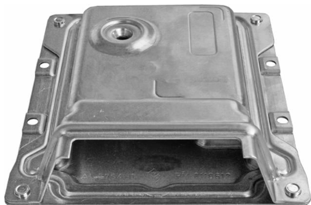
» Proizvodna enota, zgrajena na osnovi stiskalnice Tox (manjša slika), v enem delovnem taktu tesno spoji 1,2 mm debelo zgornjo ploščo in 1 mm debelo spodnjo ploščo s štirimi okroglimi klinč spoji Tox premera 6 mm.
