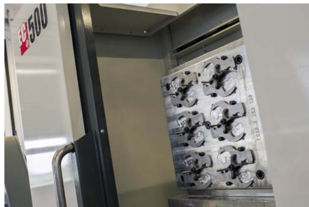
» Haas EC 500 lahko s posebnimi vpenjalnimi pripravi obdelava več rezil v enem samem vpetju.
