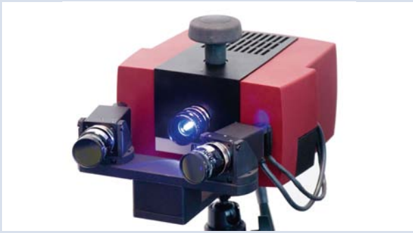
» Slika 2: 3D-skener ATOS CS 5M, nova pridobitev na Tecosu, omogoča boljšo točnost, večjo fleksibilnost in možnost avtomatizacije meritev. (Foto: Boštjan Čadej)
