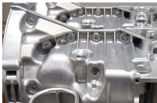
► Slika 2: Slika čistega ulitka, na katerem stopnje čistosti ne moremo več določiti vizualno
