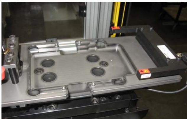
» Čitalnik prebere črtno kodo na zgornjem pokrovu ohišja in skupaj z zaznavalom na desni strani, ki preverja prisotnost in pravilno lego komponente, odobri začetek spajanja. Slike: Tox
