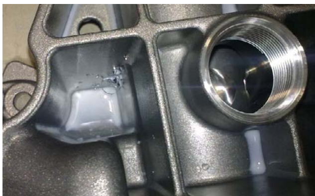
► Slika 1: Slika umazanega ulitka, onesaženega z obdelovalno emulzijo in kovinskimi odrezki
