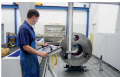
› Portalni 3D-merilni stroj Zeiss MMZG ima merilno območje 2500 x 4000 x 2000 mm.
