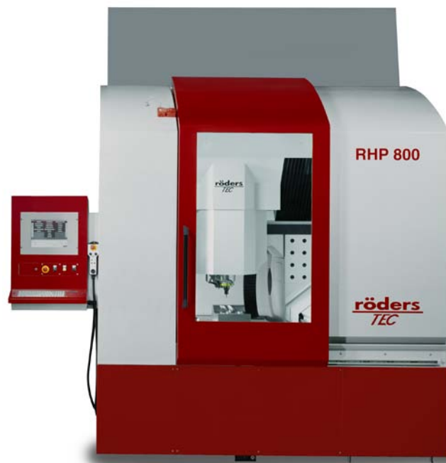
» Visokohitrostni rezkalni stroj RHP 800 je nastal leta 2001, opremljen je s hidrostatskimi vodili in linearnimi motorji na vseh oseh. Stroj omogoča zelo visoko statično in dinamično natančnost ter zagotavlja zelo dobro kakovost površine.
