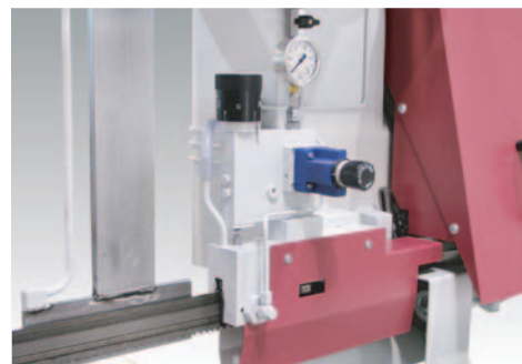
Slika 1: Robustni dvžni valji in vpenjalne čeljusti
