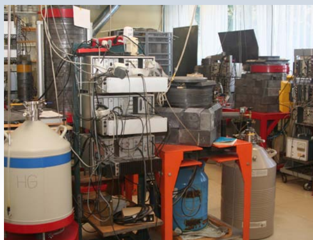
► Pogled na spektrometre v laboratoriju za radiološke merilne sisteme in meritve radioaktivnosti. Spektrometre obdajajo svinčeni ščiti, katerih namen je zmanjšati ozadje iz okolja in povečati občutljivost meritev
