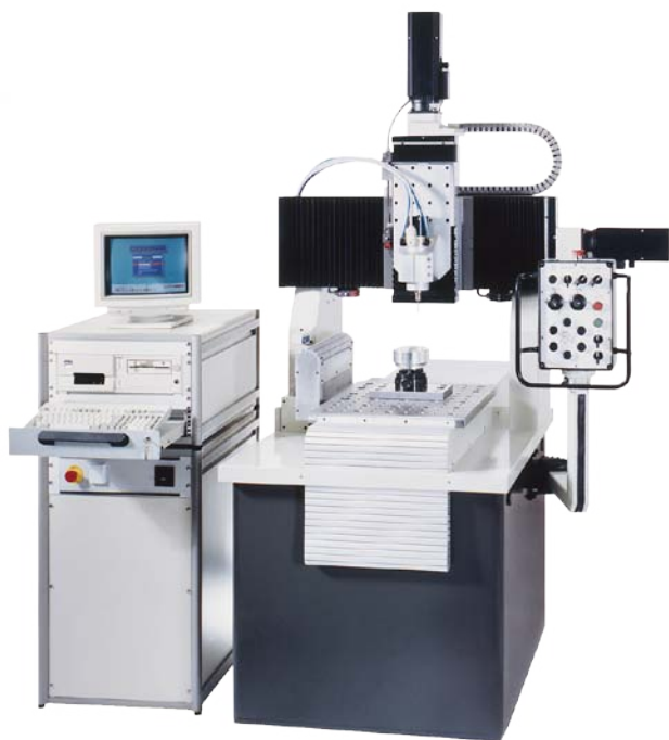
» Prvi visokohitrostni rezkalni stroj HSM 520 iz leta 1991 je imel še krmilje na osnovi osebnega računalnika s procesorjem 486 in taktom 33 MHz.
