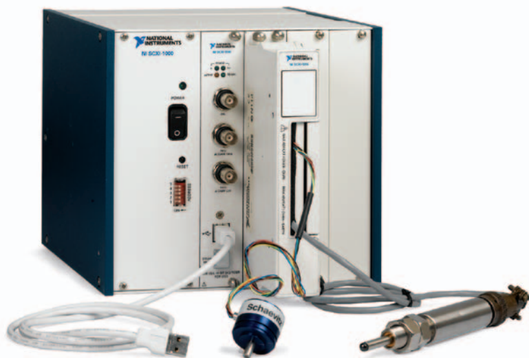
» Slika 7: Platforma SCXI zagotavlja stroškovno najučinkovitejšo rešitev za več kot 300-V meritve z velikim številom kanalov.
