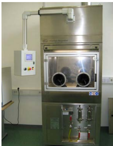
► Slika 7: Kabinet za ekstrakcijo nečistoč na osnovi tlačnega izpiranja
